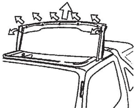
Ouvrez le toit ouvrant en ôtant les 7 boutons pressions à l'avant. Détacher la capote de l'avant en tirant sur la barre vers le haut tout en tenant en position verticale.
