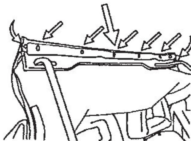
Fixer la capote sur l'arceau au dessus de la lunette arrière à l'intérieur (fig.,16). Fixer la capote vers l'avant (fig.,17).
