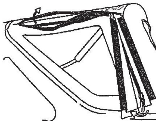
Relâchez la partie supérieure et arrière des vitres latérales, puis ouvrez complètement les fermetures éclair de la fenêtre.
