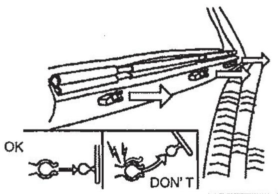
Retirer la lunette arrière en libérant le velcro en bas au coins de la fenêtre, puis défaire le zip. Il y a une tige à travers le bord inférieur de la fenêtre, qui est clipsée sur l'arrière de la tige de la porte. Enlever les clips, en les tirant horizontalement à partir du hayon.
