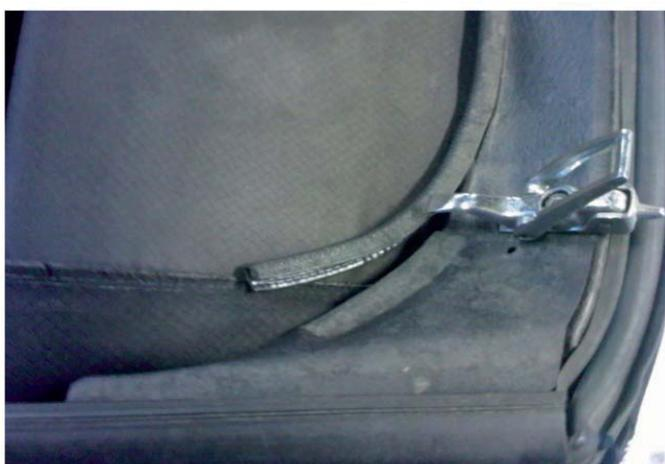
Déposer partiellement le joint avant.
