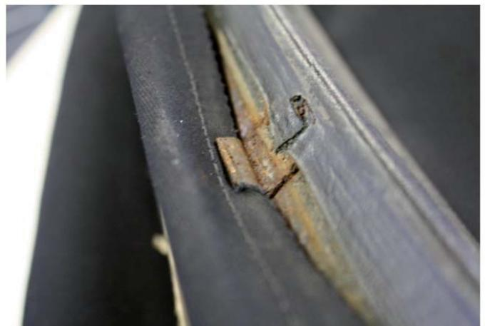
Monter la capote sur l'avant et passer les passe-poils sous les fixations. Replacer les fixations pour bloquer la capote.
