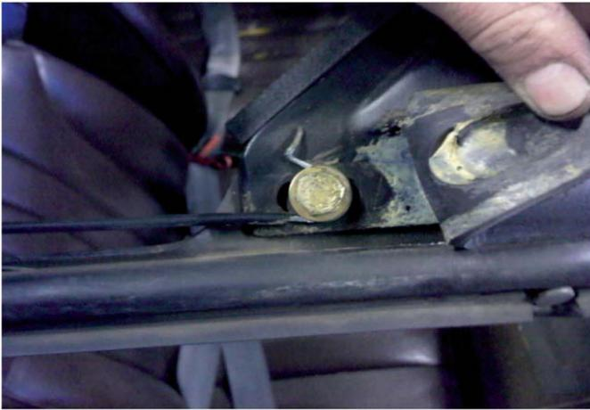
Décoller les mousses sur la partie avant de l'arceau de casquette pour accéder aux écrous de fixation des câbles latéraux.
