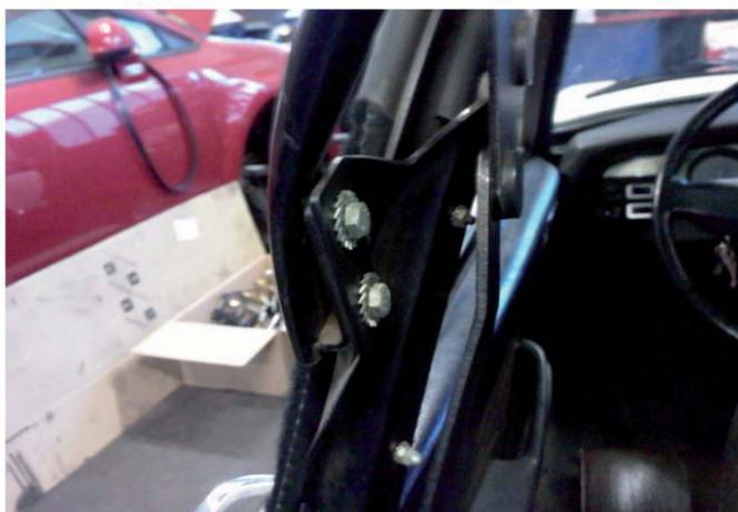
Retirer les 2 vis (côté gauche et droit) pour déposer la barre arrière.
