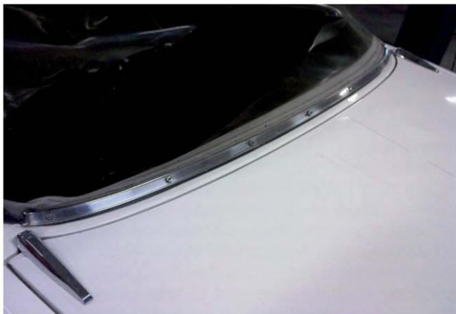
Déposer la baguette en aluminium qui maintient l'arrière de la capote.
