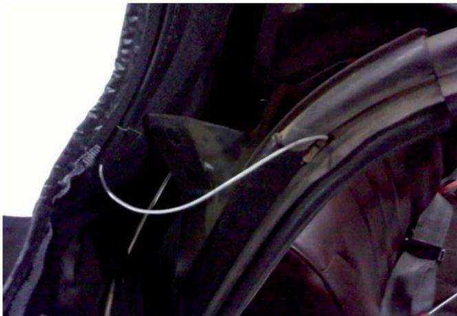
Remonter les câbles de maintien latéraux neufs dans la capote. L'arrêt de câble passe dans le trou de l'axe de l'arceau central.
