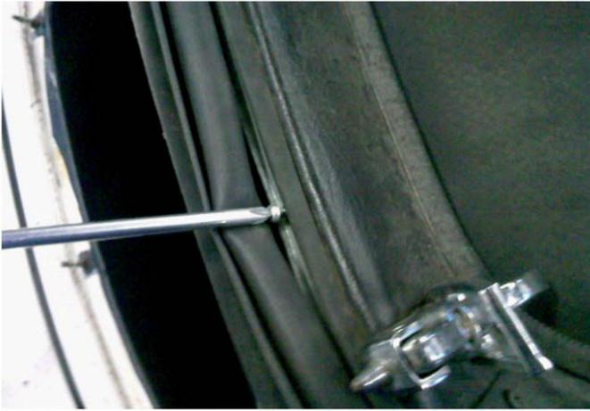
Dévisser le joint avant (les vis sont cachées sous le joint).
