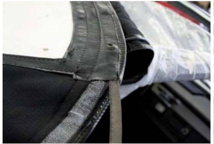
Passer la barre de renfort arrière dans son logement (récupérer la barre sur l'ancienne capote, traiter et repeindre si nécessaire).
