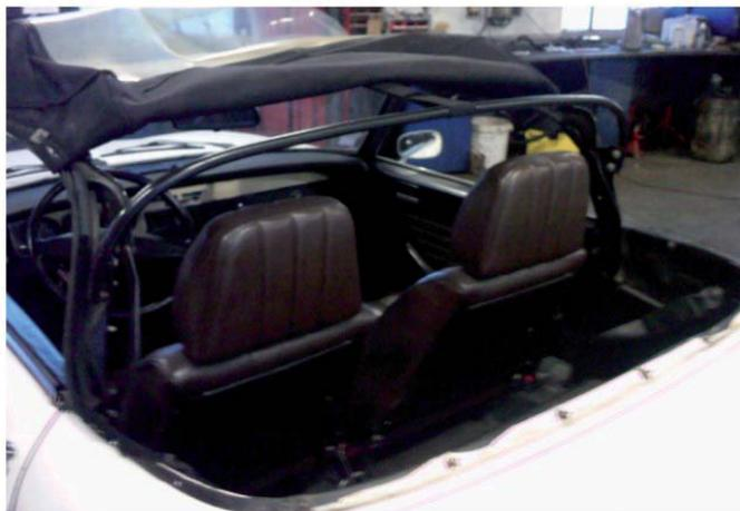
Dégrafer les côtés, puis basculer la capote sur l'avant.
