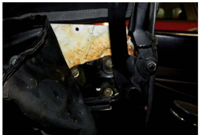
Si la capote ne ferme pas, il faut desserrer les vis de fixation de l'arceau de capote.
