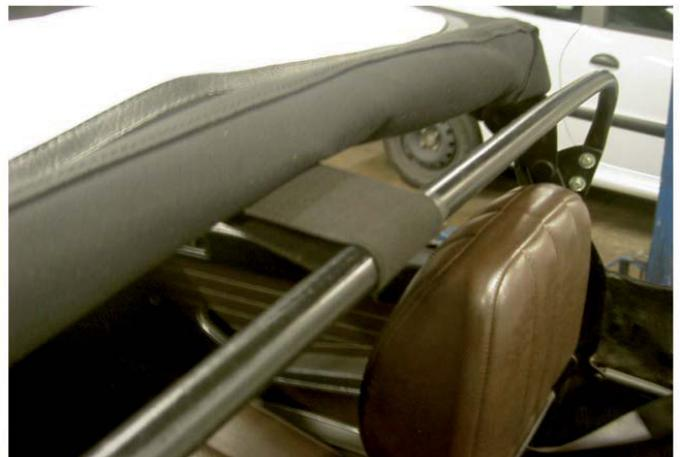
Remonter la barre transversale, en prenant soin de replacer le tendeur.
