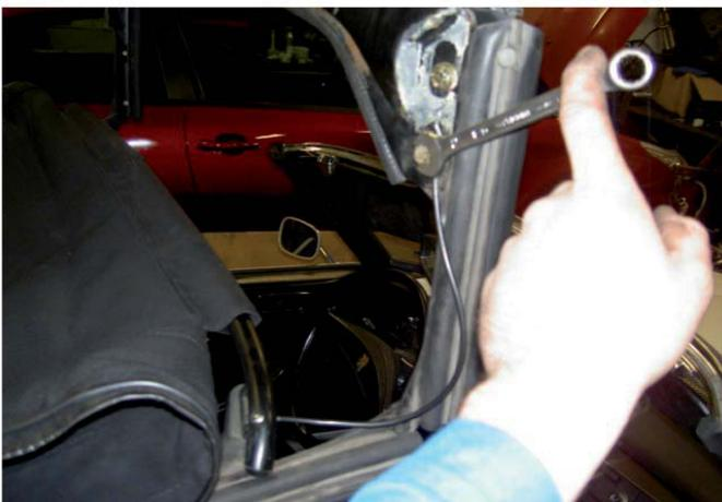
Relever légèrement la capote, retendre un peu et serrer fermement.
