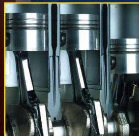
Les segments de piston assurent l'étanchéité de la compression.
