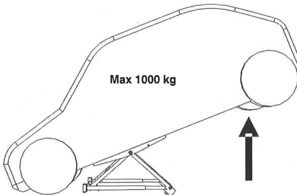
Lorsque vous choisissez de lever le véhicule soit de l'avant ou de l'arrière, laissez 2 roues au sol impérativement. La charge maximale de levage est de 1.000 kgs dans cette position.
