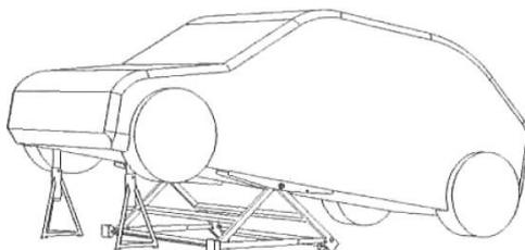
Interdit de travailler sous le véhicule sans l'avoir positionné sur le cran de sécurité.
