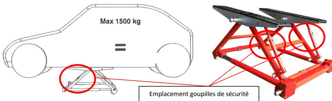
Lorsque vous désirez lever le véhicule de ses 4 roues, la capacité maximale de charge est de 1.500kgs, pour cela, il est impératif d'aligner le centre de gravité du véhicule avec l'axe central du pont, ainsi lors du levage, vous pourrez insérer les goupilles de sécurité pour bloquer le pont en position horizontale.
