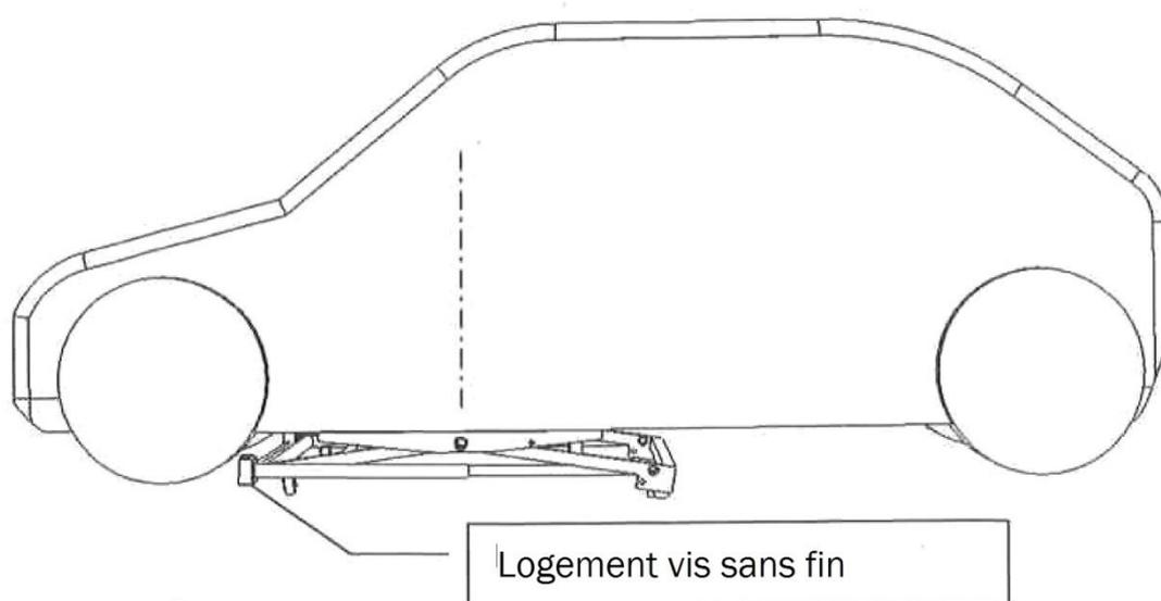
Pour lever l'arrière du véhicule, montez doucement le mini pont en laissant les 2 roues avant posées au sol, en cas de besoin, de façon manuelle, soulevez l'arrière du véhicule et dans la position voulue, insérez les goupilles de sécurité (cf page 5/9), de part et d'autre du mini pont.
