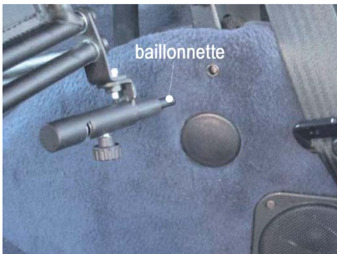
Percer Ø7mm les panneaux latéraux
