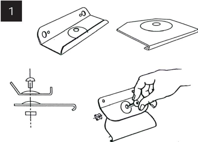
■ Fixer les attaches avants (*gauche et droite*) aux supports.
