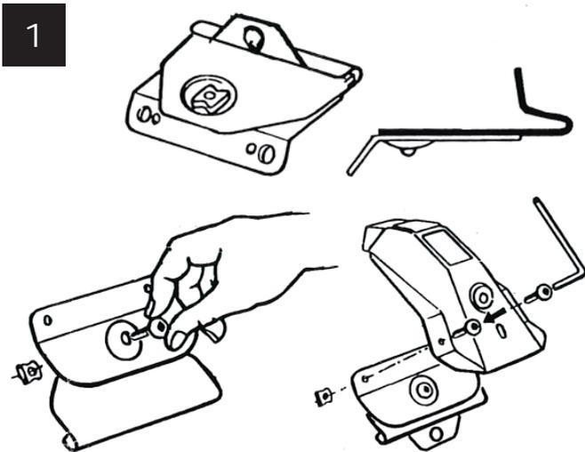
■ Fixer les attaches avants (*gauche et droite*) aux supports.
