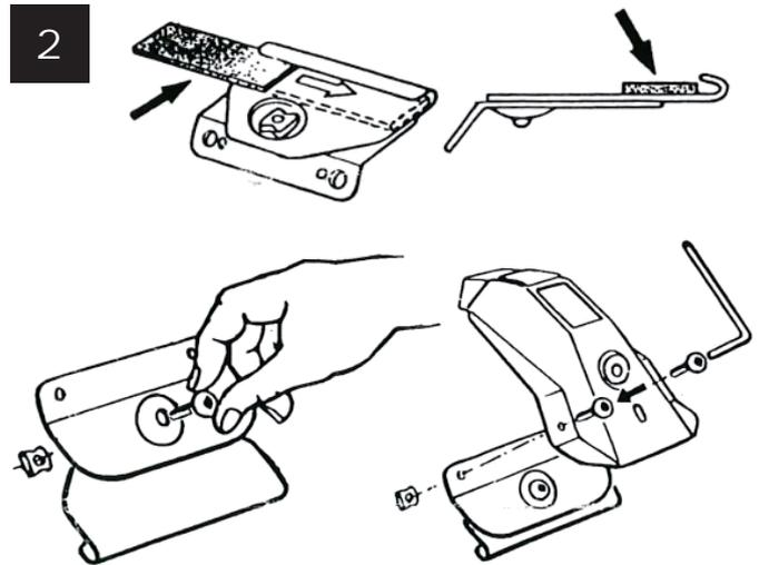
■ Fixer les protections plastique aux attaches arrières (*gauche et droite*), puis fixer les attaches aux supports.
