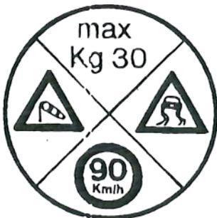
**ATTENTION important** - Chaque charge supplémentaire sur le porte-bagages change la conduite normale de votre véhicule. De ce fait il y a lieu de conduire prudemment et si nécessaire réduire la vitesse de votre véhicule, particulièrement sur autoroute et par mauvais temps.
